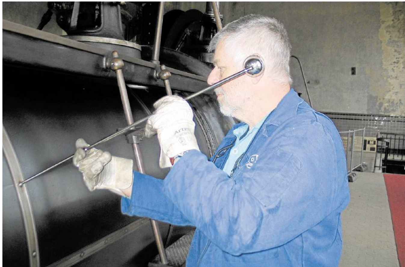
Rolf Lämmerhirt, Mitglied in der AG Dampfmaschine, prüft mit dem Defektsucher die schwarze Maschine.
