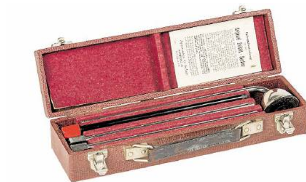
Der Defektsucher, Hersteller Apparatebau C. Richter, Hamburg, in seinem Aufbewahrungskoffer. Er diente zum Abhören der Dampfmaschine nach Störgeräuschen.
