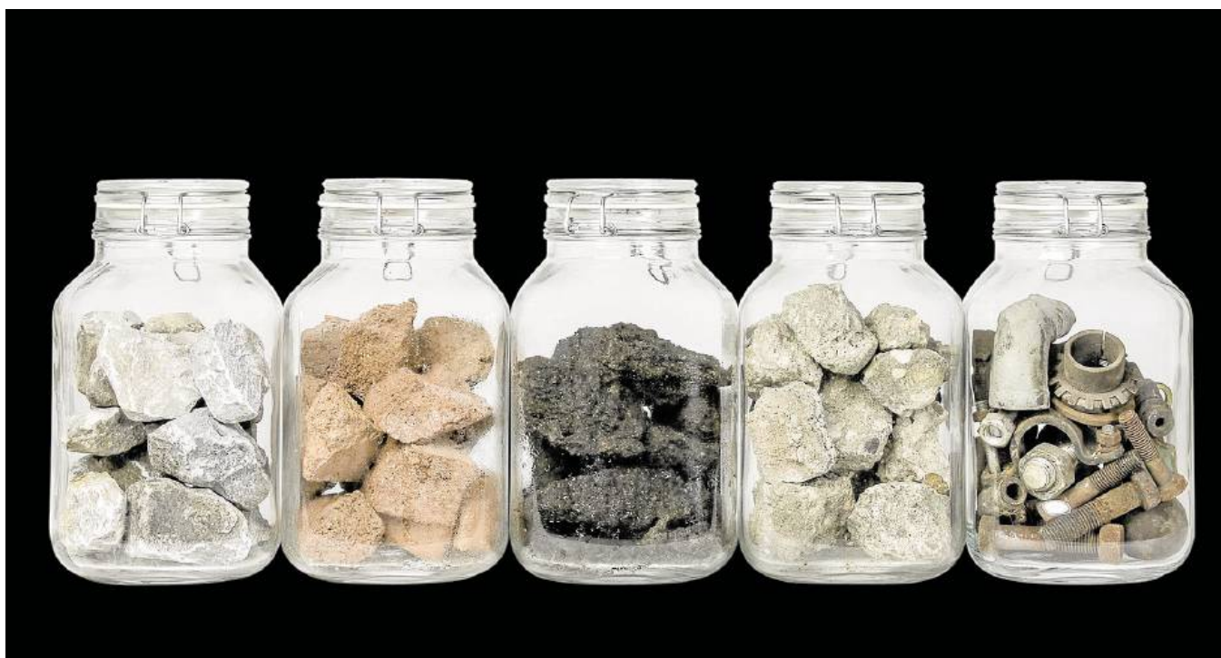
Das sortierte Abbruchmaterial: Beton, Ziegel, kontaminierte Erde, Zement und Schrott (v.l.).
