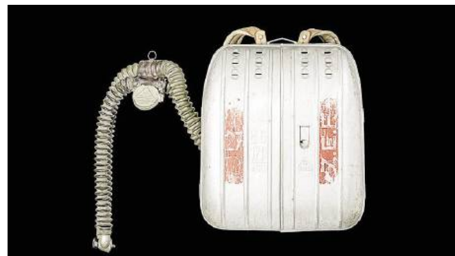
In diesem ausgestellten Aluminium-Tornister der Grubenwehr steckt ein Atemschutzgerät Dräger BG 170/400.
