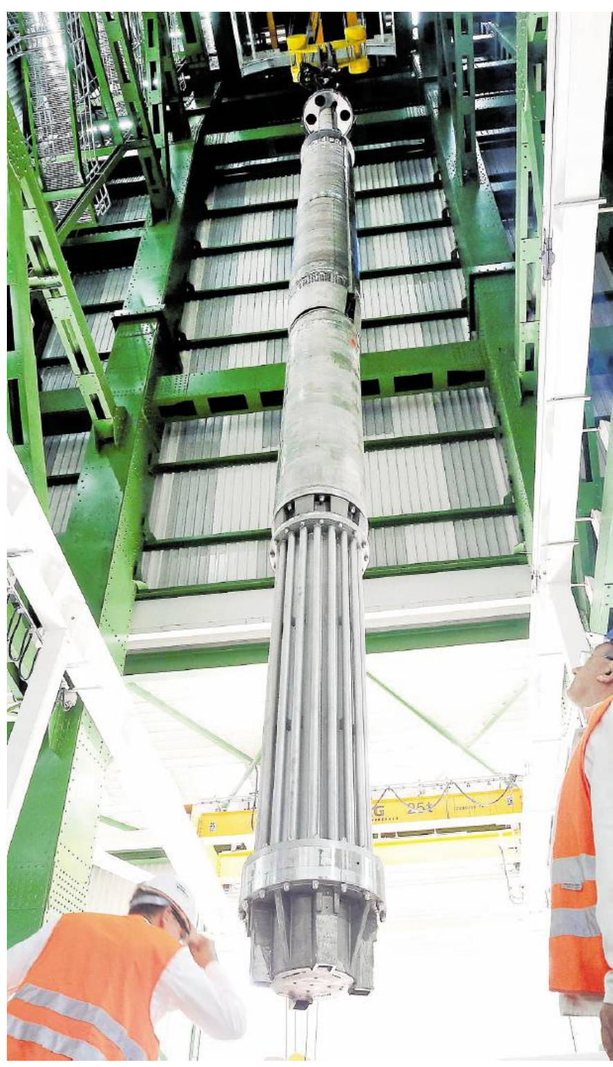
Tauchpumpe im Schachtgerüst des ehemaligen Bergwerks Duisburg-Walsum. Mit solchen Pumpen will die RAG die Wasserhaltung auf einen Brunnenbetrieb umstellen. Das spart Kosten und erleichtert die Wartung, weil keine Grubengebäude mehr betrieben werden müssen. FOTO DPA
