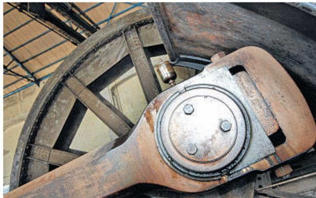
Die Koescheibe wartet darauf, bald mit Hilfe von Reibrädern wieder angetrieben zu werden.
