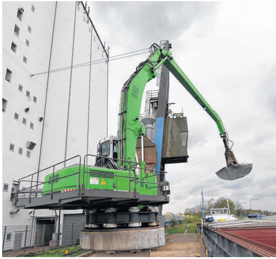
Rohware wird per Schiff angeliefert und mit einem fest verankerten Bagger entladen. Wie Dorsten haben die meisten Agravis-Standorte Anschluss an eine Wasserstraße.
